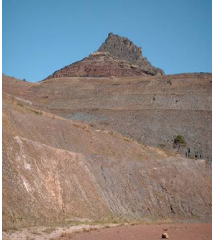
Foto 3.1 - Taludes em filitos dolomíticos na parede Leste da Mina do Pico (24 /08/2007).
