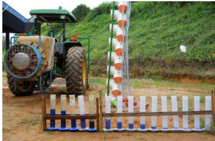
Figura 7. Dispositivo usado para medir a uniformidade de distribuição volumétrica vertical.
