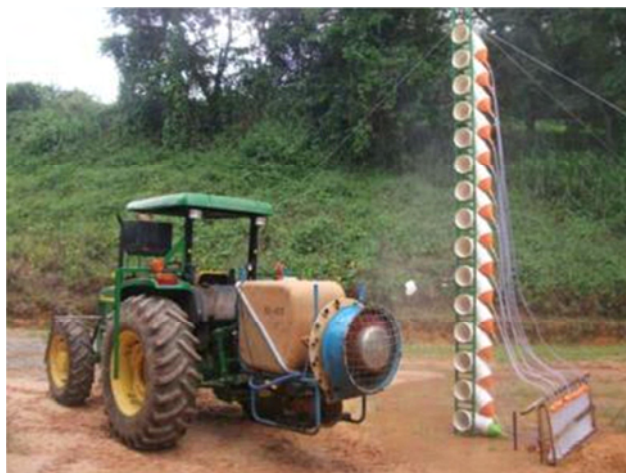
Figura 4. Coletor vertical usado na determinação da uniformidade de distribuição volumétrica.
