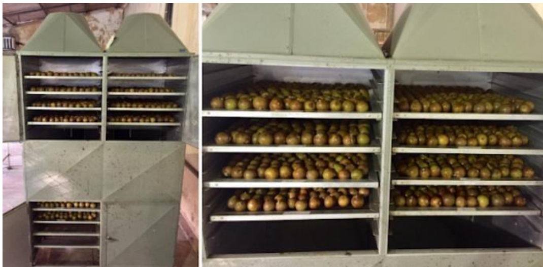
Figura 3: Secador vertical com circulação forçada de ar.
