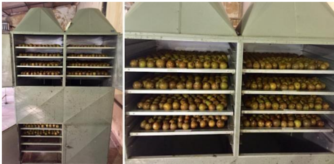
Figura 11: Secador vertical com circulação forçada de ar.
