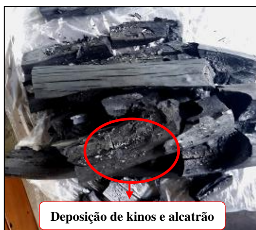
Figura 5. Deposição de alcatrão no carvão vegetal do clone AEC0043 de 11 cm de diâmetro
