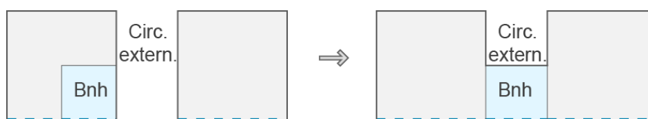
Figura 55: Exemplo de posicionamento de uma área molhada na parte externa da edificação. Fonte: Autor.
