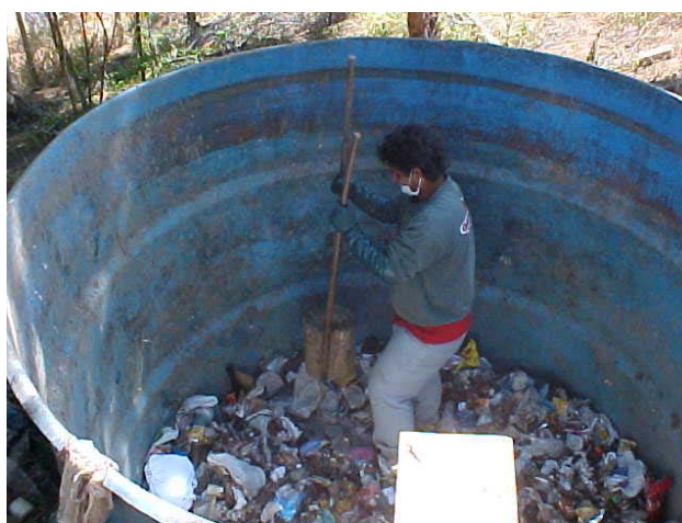
Figura 6 – Compactação dos RSU com o soquete de madeira.
