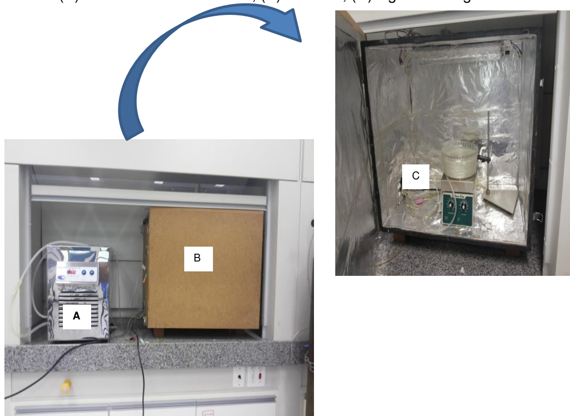
Figura 2. Câmara utilizada durante os procedimentos de extração de voláteis por HS-SPME: (A) Banho ultratermostático; (B) Câmara; (C) Agitador magnético.
