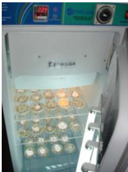
Figura 4 – Câmara de incubação, com fotoperíodo, tipo B.O.D., para desenvolvimento de estruturas fúngicas presentes nos grãos de milho.
