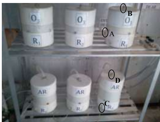
Figura 3 – Recipientes cilíndricos utilizados para acondicionamento dos grãos de milho submetidos ao ozônio e ao ar atmosférico: A) Entrada de ozônio; B) Saída de ozônio; C) Entrada de ar atmosférico; D) Saída de ar atmosférico.
