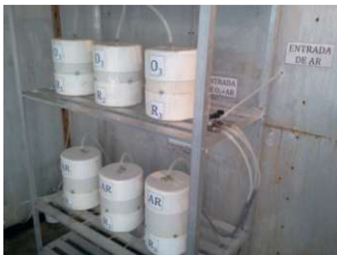
Figura 2 – Recipientes cilíndricos utilizados no sistema de ozonização.
