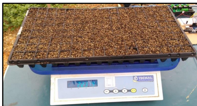
Figura 8: Bandeja sobre balança representando esquema da lisimetria de pesagem.
