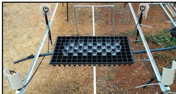
Figura 7: Montagem utilizada para teste de uniformidade de distribuição de água com 4 emissores por bandeja, igualmente espaçados e posicionados próximos às quinas da bandeja.
