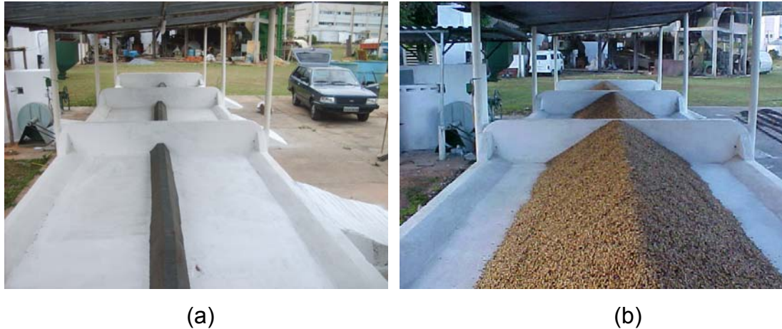
Figura 12 – Secador de leito fixo em leiras, sem carga (a) e com carga (b).
