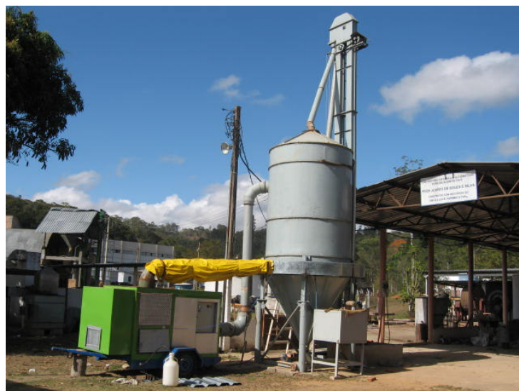
Figura 7 – Vista parcial do secador de café em lotes intermitentes de fluxos concorrentes.
