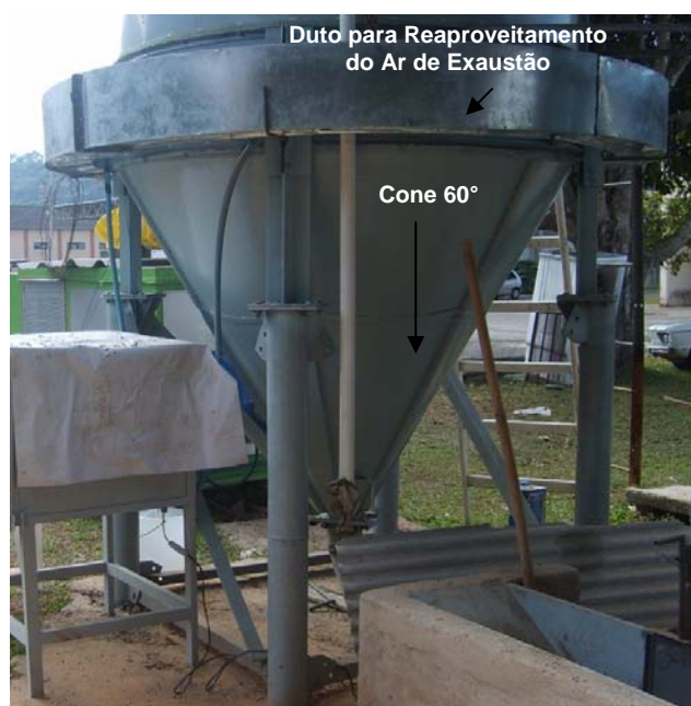
Figura 8 – Duto para reaproveitamento do ar de exaustão e cone com 60^\circ de inclinação.
