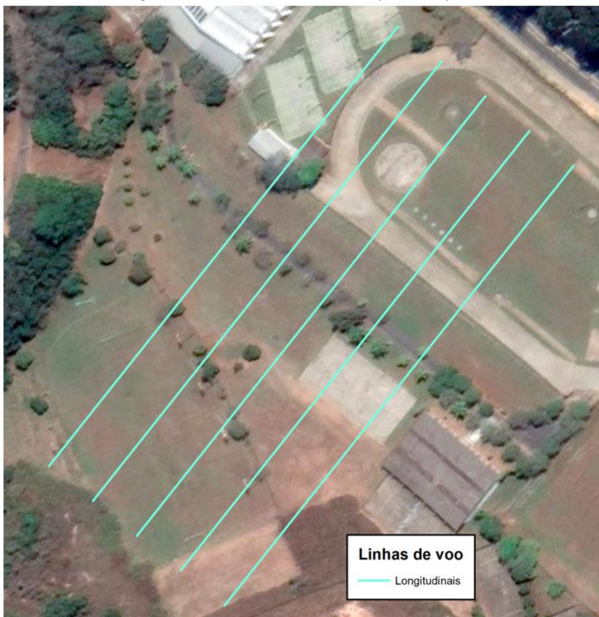
Figura 15 - Plano de voo a 70m realizado para o campo EFI
