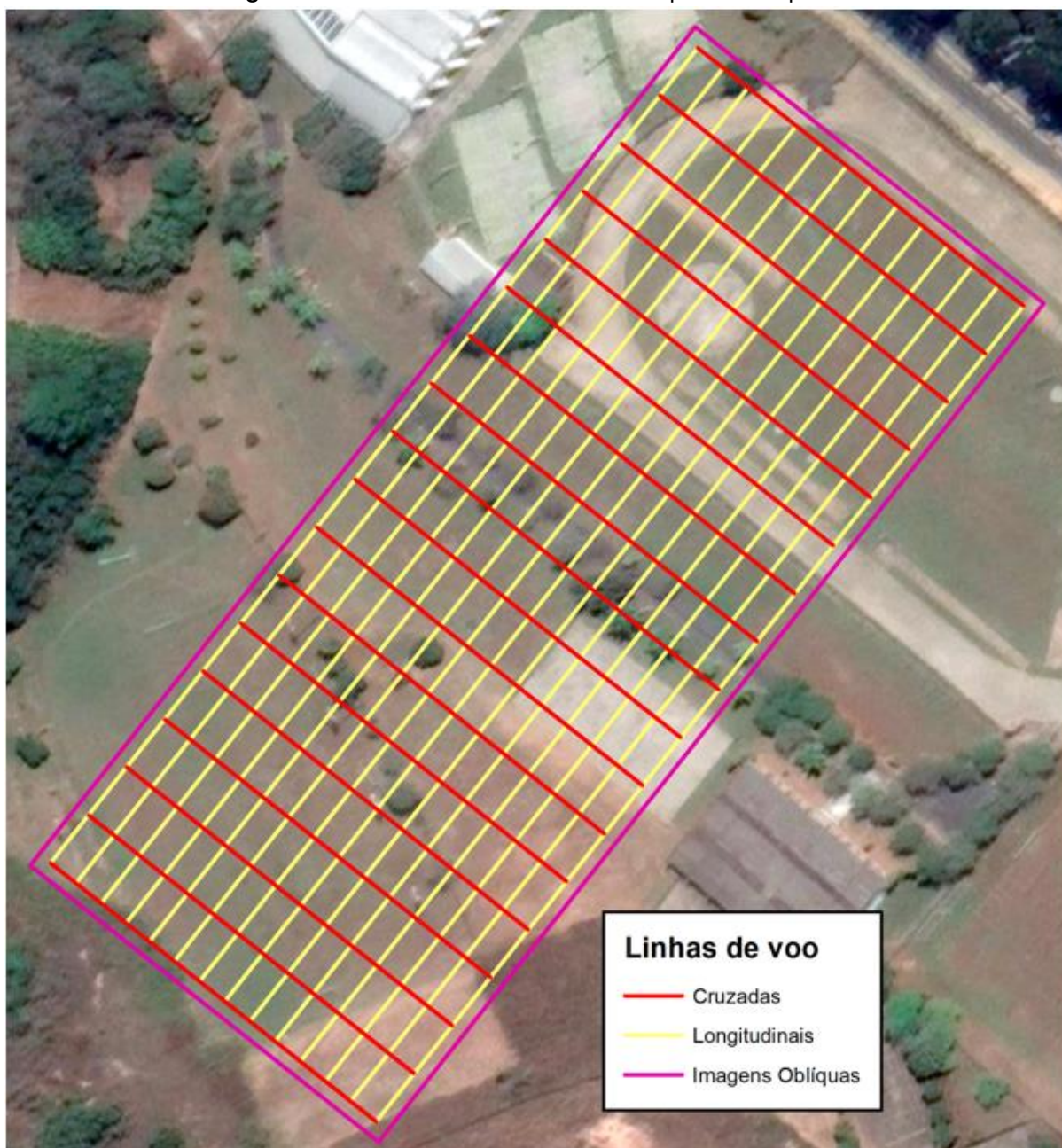
Figura 13 - Plano de voo a 40m realizado para o campo EFI
