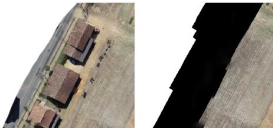
Figura 20 - Comparação de uma mesma área de duas ortoimagens, uma sem as imagens levantadas editadas para geração da ortoimagem (à esquerda), e a segunda com as imagens editadas (à direita), para deixar apenas a área de estudo
