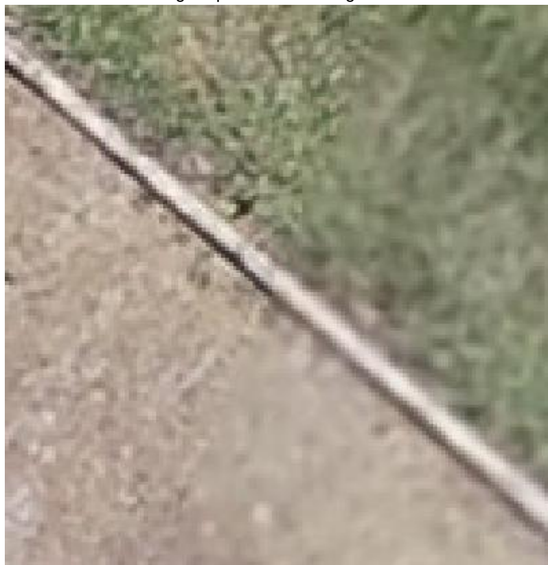
Figura 31 - Efeito causado na ortoimagem pelo uso de imagens de linhas de voo de diferentes alturas
