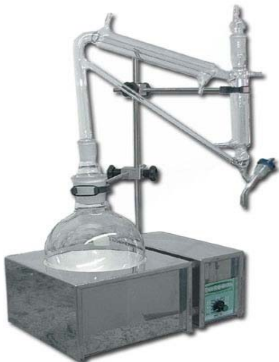
Figura 5 - Aparelho de Hidrodestilação Clevenger usado para a extração do óleo essencial.
