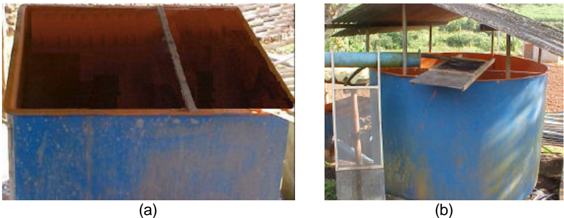
Figura 3 - Detalhe do reservatório inferior mostrando os dois compartimentos (a) e do reservatório intermediário com as telas utilizadas nos ensaios (b).
