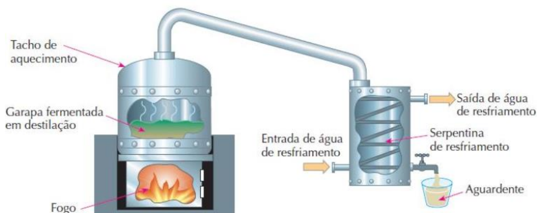
Figura 1: Esquema de um alambique para fabricação de aguardente
