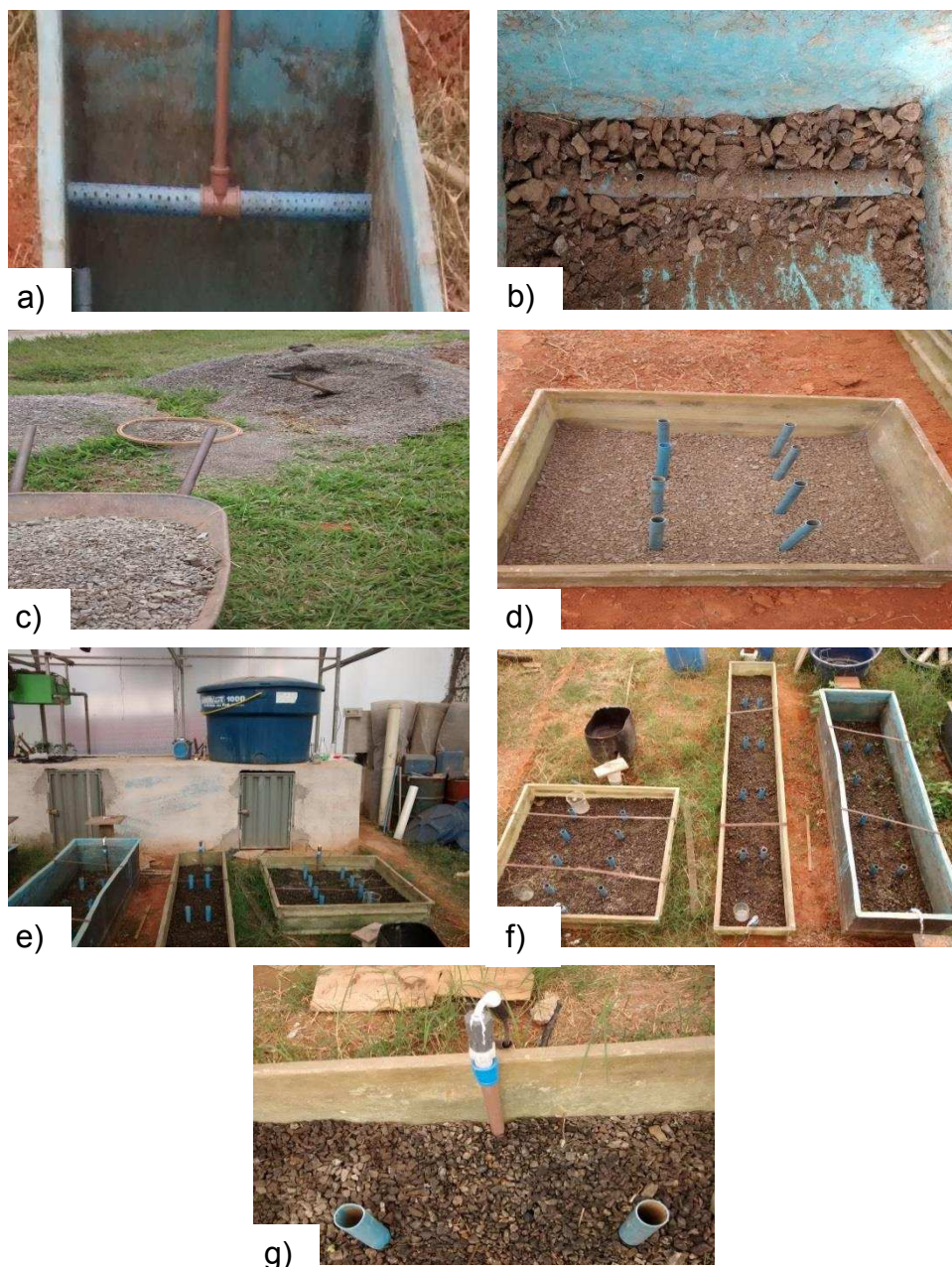
Figura 4 – Montagem dos SACs-EHSS e detalhe das principais estruturas. a) sistema de distribuição do afluente. b) sistema interno de captação do efluente. c) peneiramento da brita para remoção do particulado fino. d) disposição dos pontos de coleta ao longo do comprimento no SAC1. e) vista do sistema, com detalhe da caixa d'água de 1000 L onde o afluente era armazenado. f) vista de cima dos três SACs-EHSS, da esquerda para direita SAC1, SAC3 e SAC2. g) parte externa do tubo de distribuição onde foi acoplada a saída da bomba.
