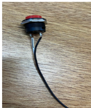
Figura 4: Conexão dos fios ao botão do tipo push button utilizado no experimento da Caixa Quântica.
