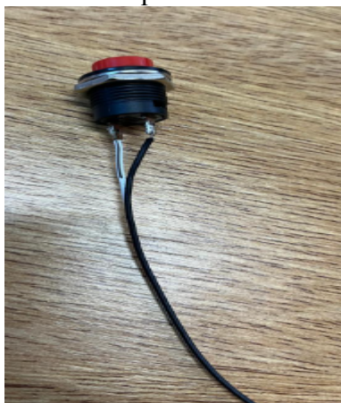
Figura 5: Conexão dos fios ao botão do tipo push button utilizado no experimento da caixa quântica.
