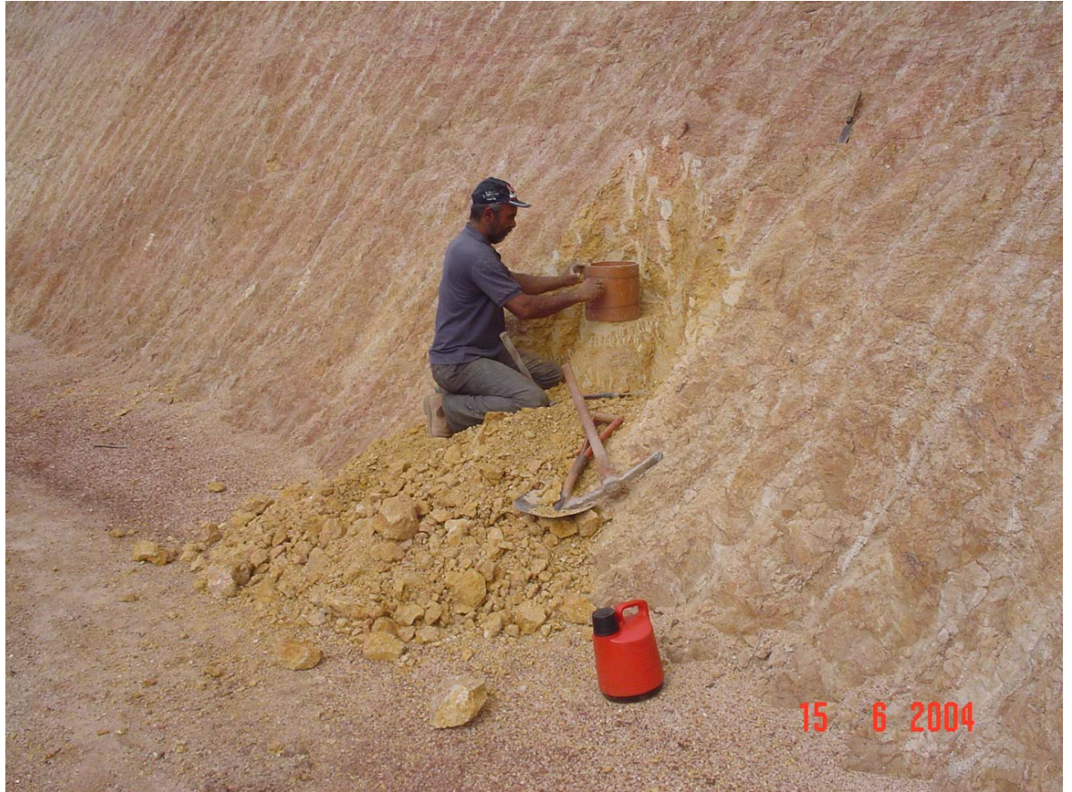
Figura 3.9 – Coleta de amostra indeformada.
