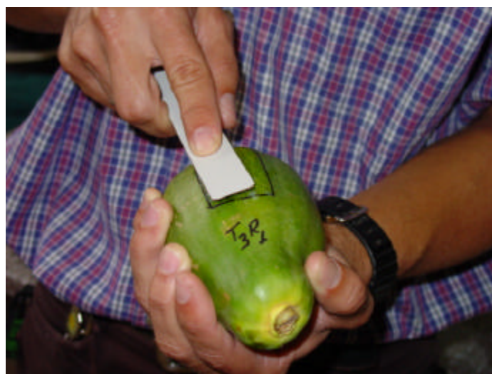
Figura 2 – Uso de lixa para simulação de injúria mecânica por abrasão em mamões.
