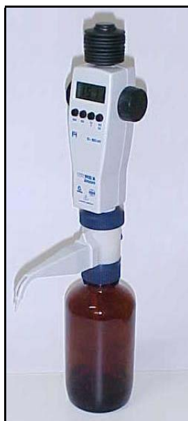
Figura 08 – Dosador automático Witeg, modelo Titrex-2000.
