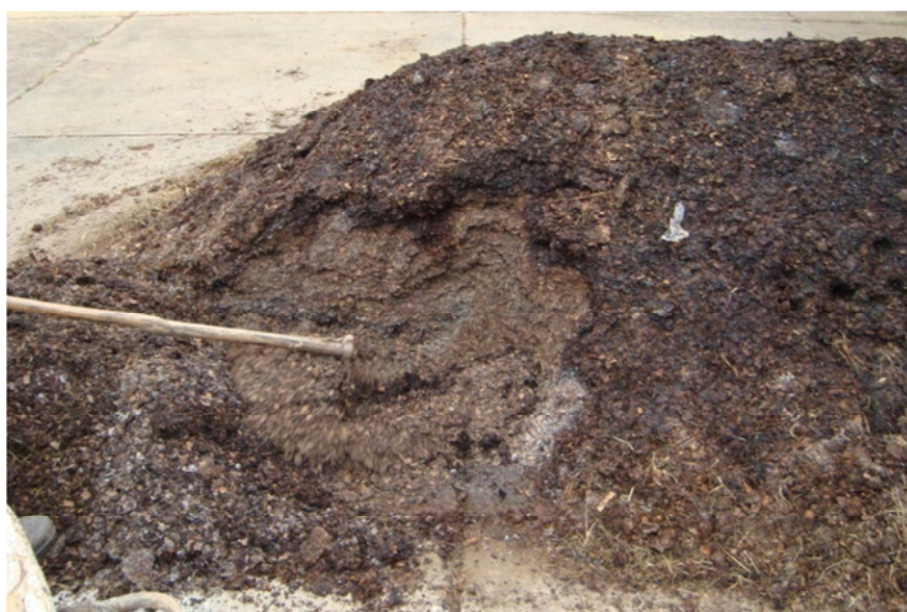
Figura 8 - Abertura da leira para correção do teor de água do material
