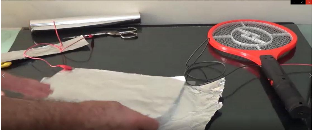
Figura 4 – Vista da montagem do capacitor de placas planas, duas folhas de alumínio separadas por uma folha de plástico. A raquete de matar mosquitos é usada como fonte de alta tensão para energizar o capacitor.
