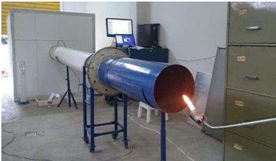
Figura 9 – Túnel de vento acoplado à câmara climática.
