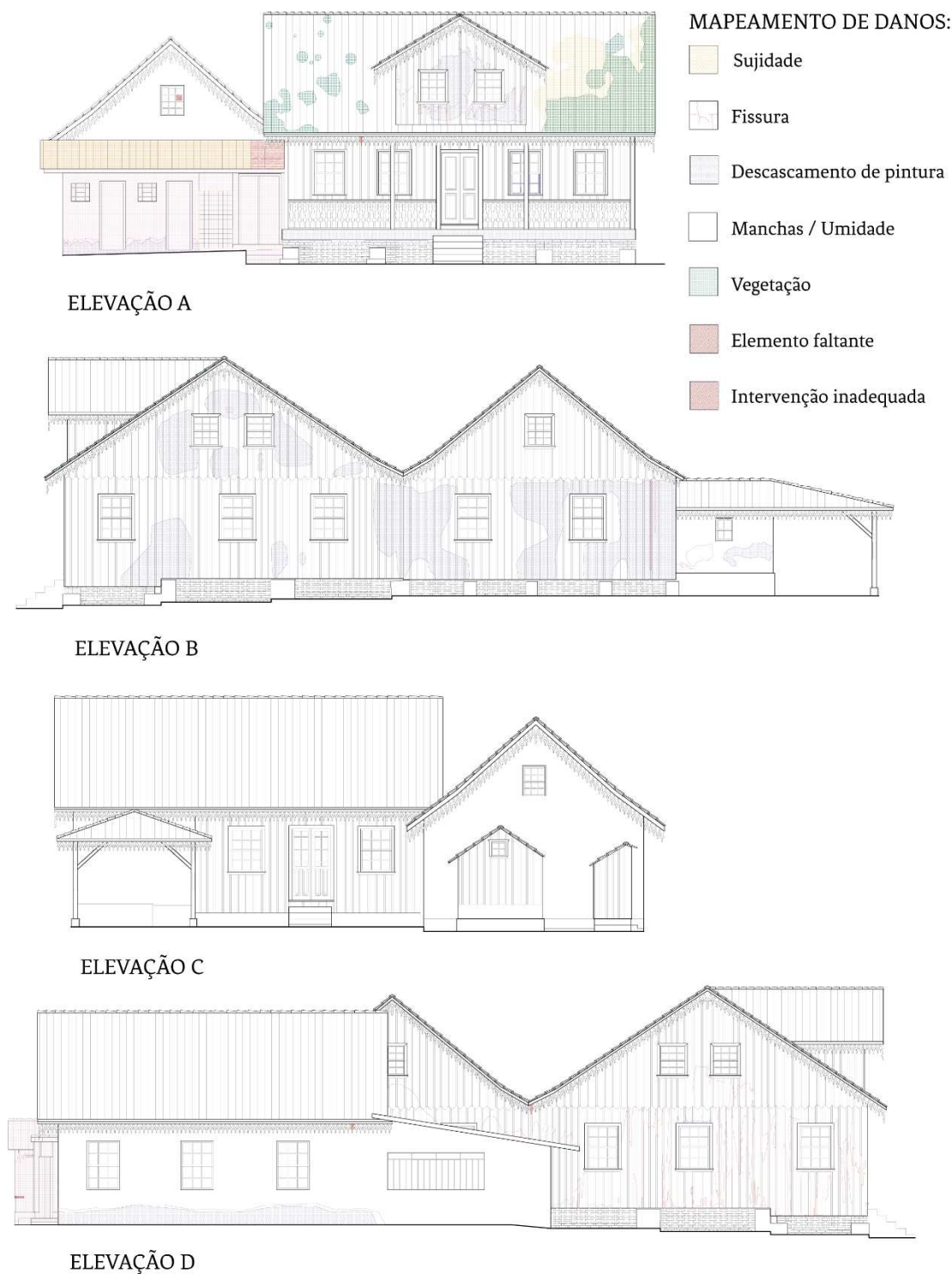
Figura 43 - Patologias representadas nas elevações 260
