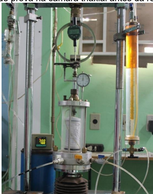
Fotografia 13 - Corpo de prova na câmara triaxial antes da realização do ensaio CIU
