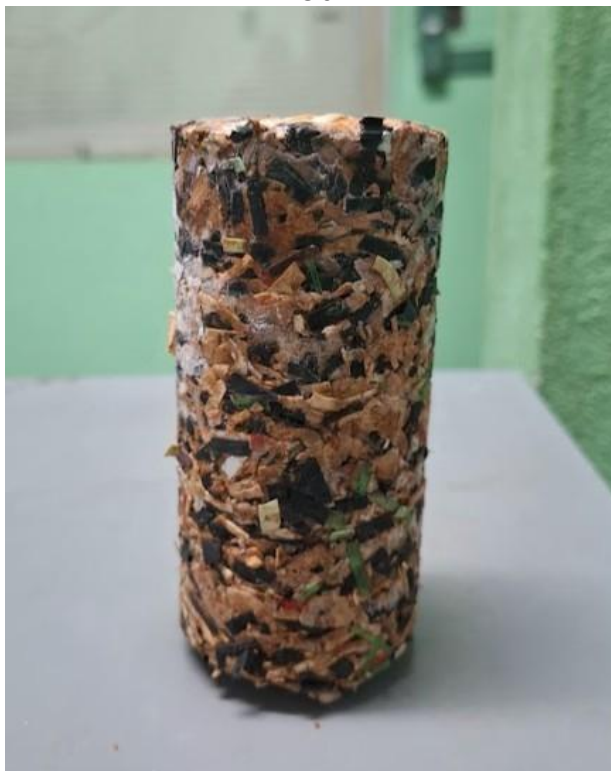
Fotografia 12 - Corpo de prova de RSMS obtido por compressão estática – Mistura MO01
