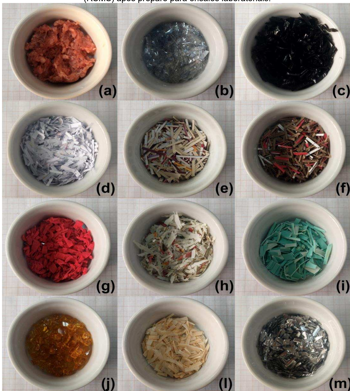
Fotografia 9 - Tamanho e forma das partículas do Resíduo Sólido Municipal Sintético (RSMS) após preparo para ensaios laboratoriais.
