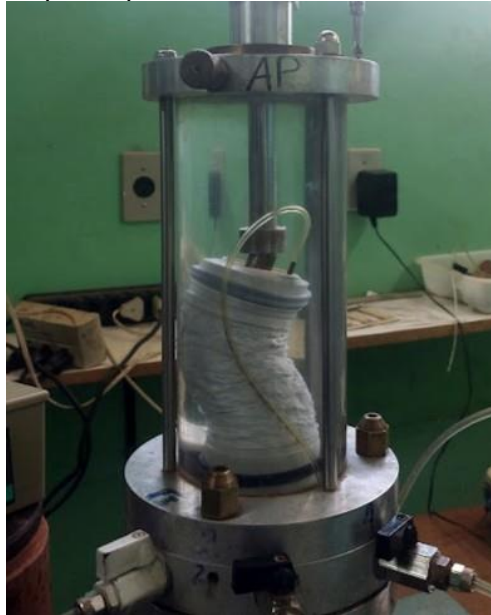
Fotografia 14 - Corpo de prova MO02 ao final do cisalhamento
