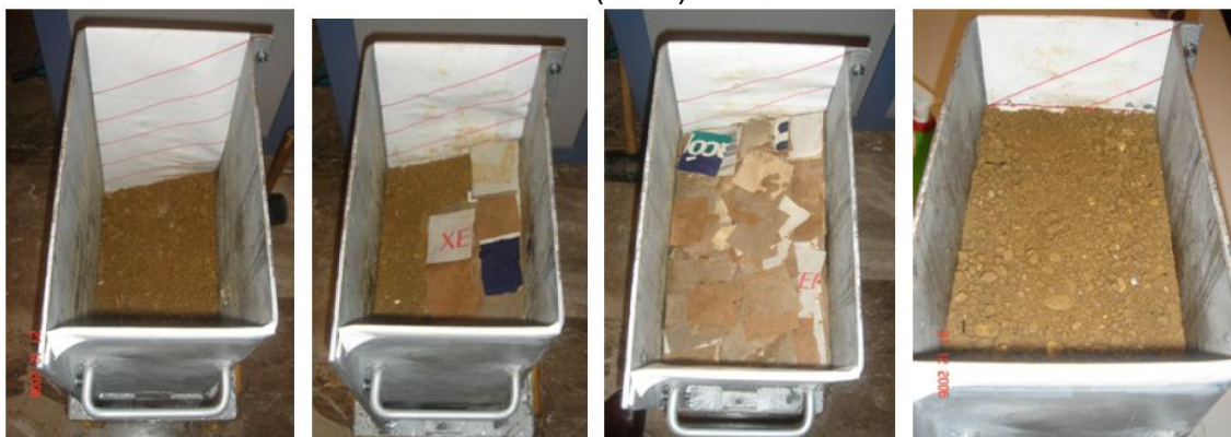
Fotografia 4 - Processo de preparação das amostras de RSMS de Athanasopoulos et al (2008)
