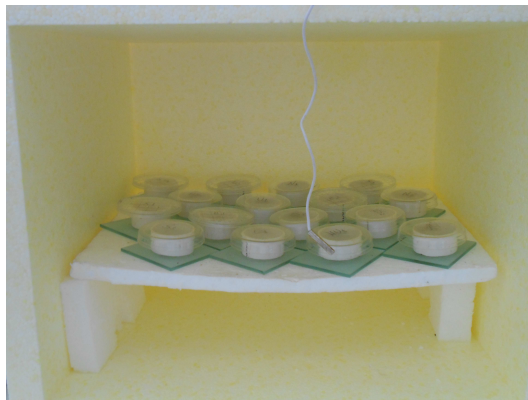
Figura 3.1: Disposição do experimento dentro da caixa térmica e sensor interno do termômetro.
