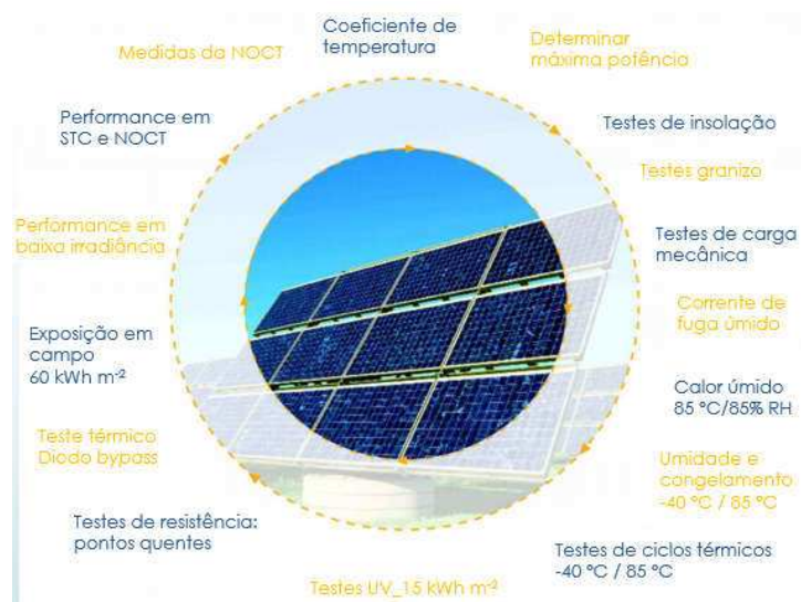
Figura 2. 7: Esquema da sequência de testes de qualificação para avaliar desempenho de módulo fotovoltaico de acordo com IEC 61215.
