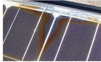
f) Escurecimento do módulo pela degradação do EVA.
