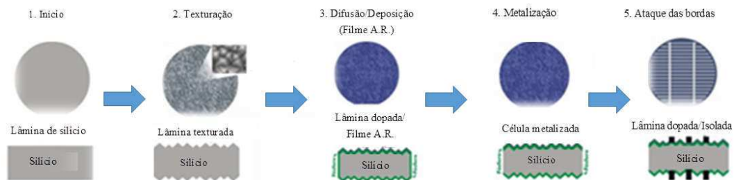
Figura 2. 3: Procedimento padrão para fabricação de células fotovoltaicas (modificada) Fonte: SANTOS JÚNIOR, 2008.
