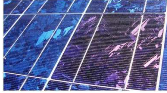
e) Descoloração da célula pela degradação do antireflectante (AR).
