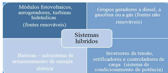
Figura 2. 22: Componentes de sistema híbrido.
