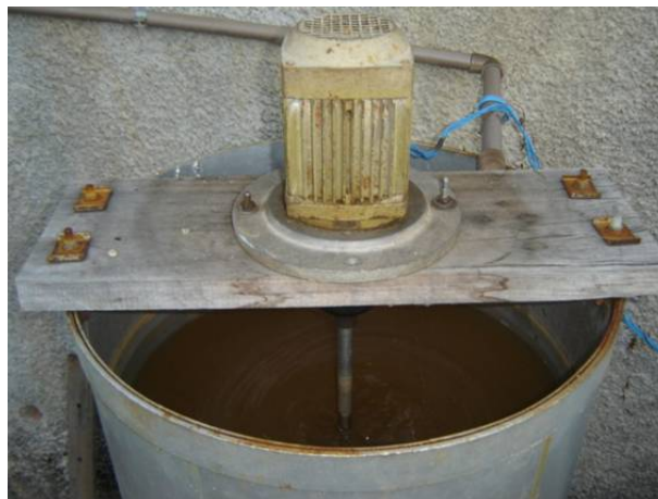
Figura 14 - ETA piloto, detalhe do tanque de inoculação de oocistos de Cryptosporidium .
