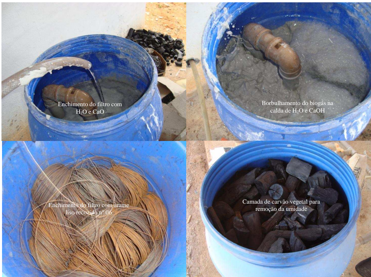
Figura 10 Detalhes do recheio do sistema de filtração.
