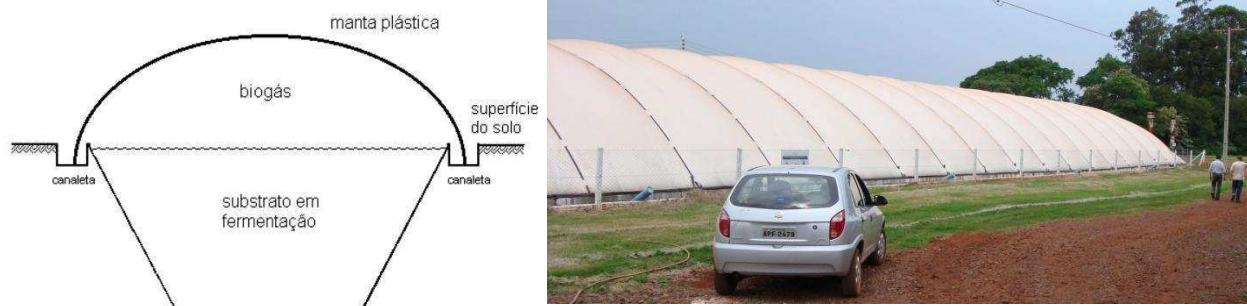
Figura 03 Ilustração de um biodigestor tubular “plug-flow”.
