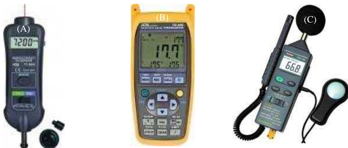
Figura 30 Equipamentos utilizados no monitoramento da rotação, temperatura e umidade relativa: A) Tacômetro da marca ICEL, modelo TC 5600; B) Termômetro digital da marca ICEL, modelo TDM890; C) Multifunção Digital da marca INSTHUTHERM, modelo THDL400 (%RH, °C, Lux, dB).
