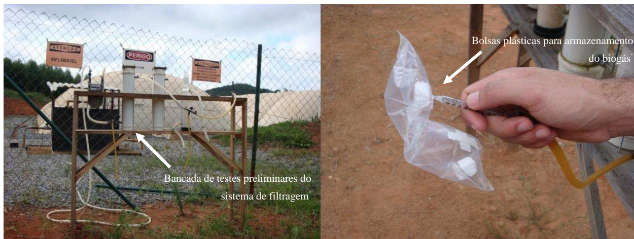
Figura 07 Vista geral do protótipo de filtragem e do sistema de coleta do biogás, para análise no cromatógrafo.
