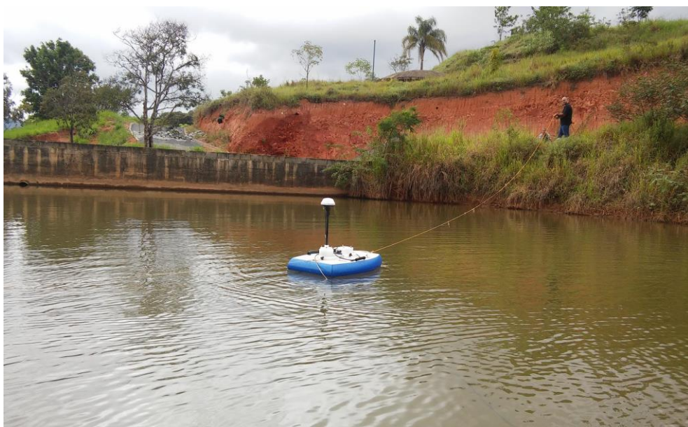
Figura 10 - Realização da batimetria na barragem com o ADP.
