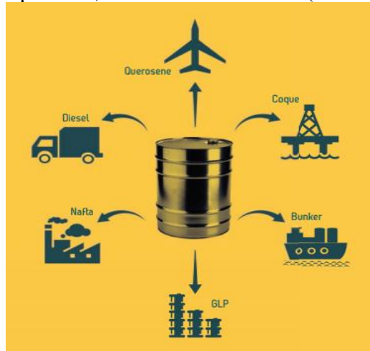
Figura 4: Principais produtos do refino de um barril de petróleo bruto, sendo eles o querosene, diesel, nafta, gás liquefeito de petróleo, combustível de navio (bunker) e o coque.
