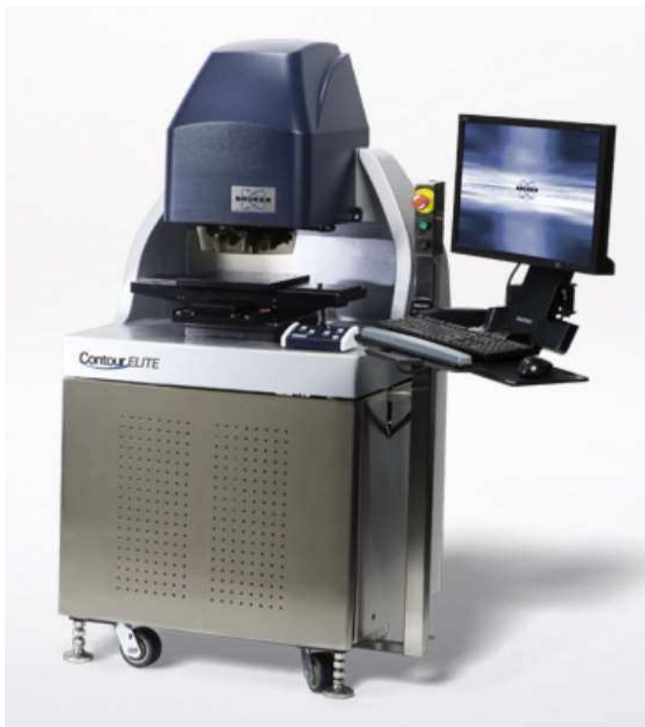
Figura A8. Perfilômetro Óptico 3D Contour Elite (BRUKER, 2017) utilizado nas análises de perfilometria dos cupons metálicos.
