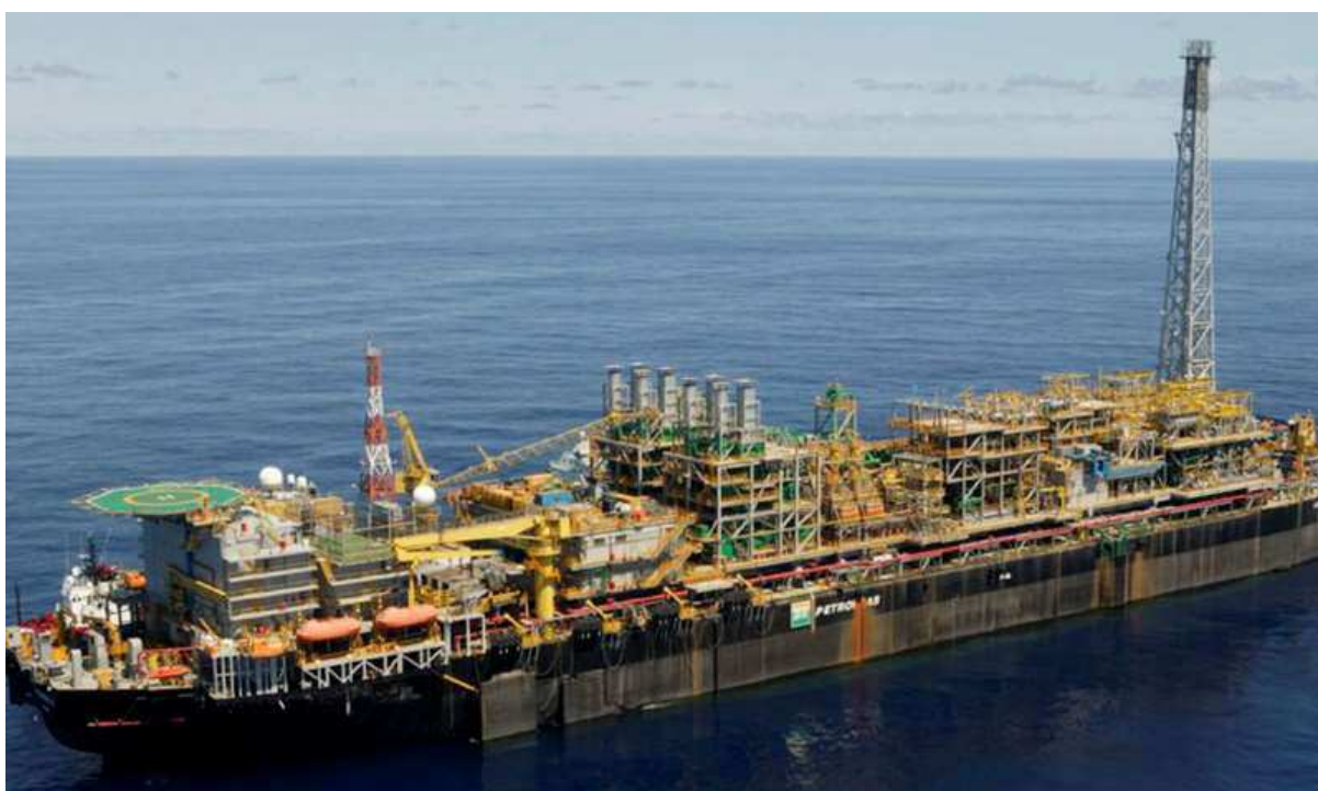
Figura 33. Plataforma do tipo FPSO ( Floating Production Storage and Offloading ), na qual foram coletadas amostras de um tanque slop para obtenção de inóculos microbianos (HEFTOS, 2021).
