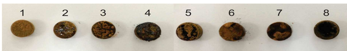
Figura 59. Aspecto visual dos cupons coletados ao longo do primeiro estudo no Looping do CENPES.
