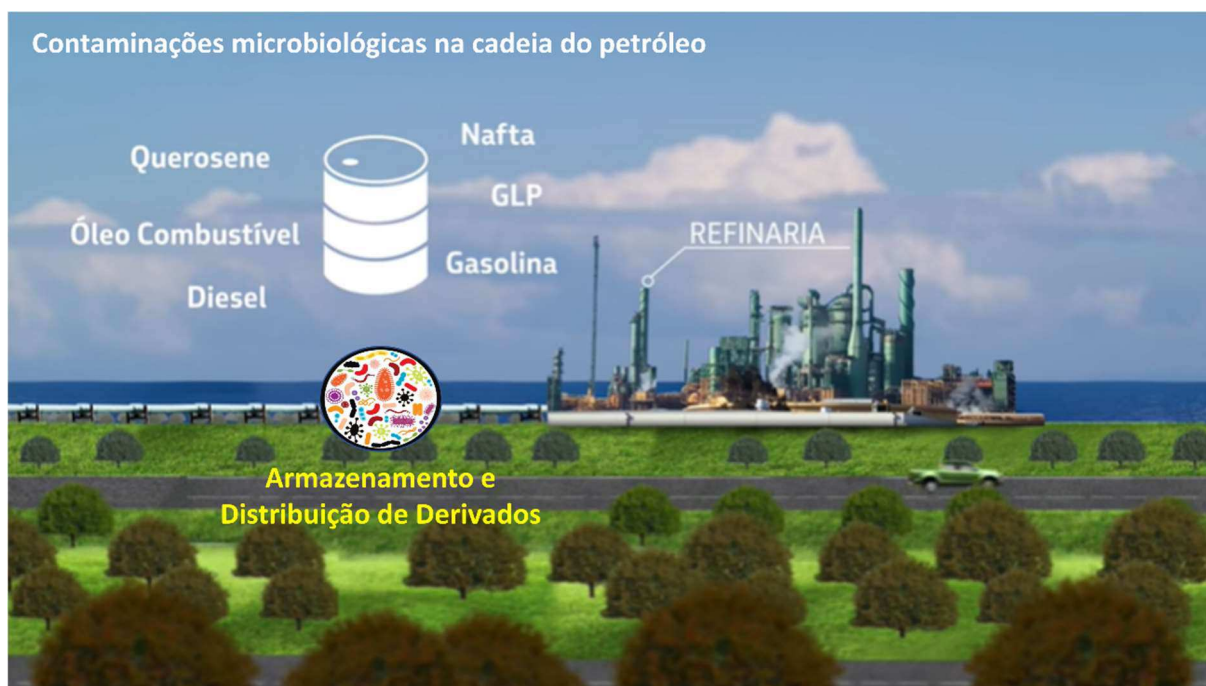
Figura 8. Sistemas da etapa de armazenamento e distribuição de derivados do petróleo susceptíveis a problemas associados a contaminações microbianas (adaptado a partir de PETROBRAS, 2016).
