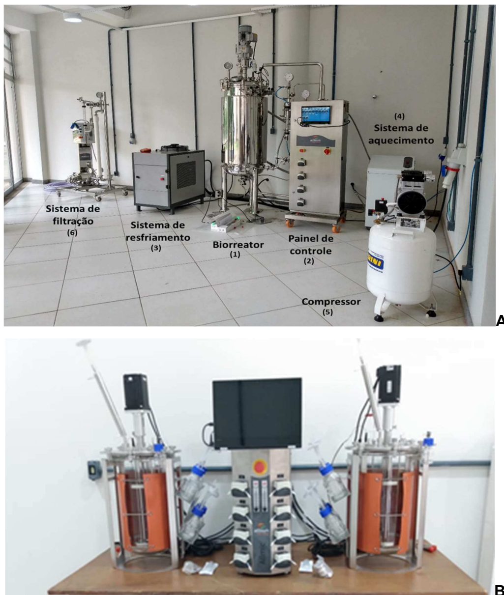
Figura 85. (A) Biorreator piloto de laboratório (200 L) e (B) fermentadores de bancada instalados na UFV para otimização e escalonamento da produção de fagos.
