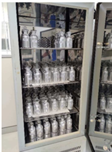
Figura 50. Frascos fechados incubados no escuro do ensaio de biodegradabilidade em água do mar (LABP, 2022).
