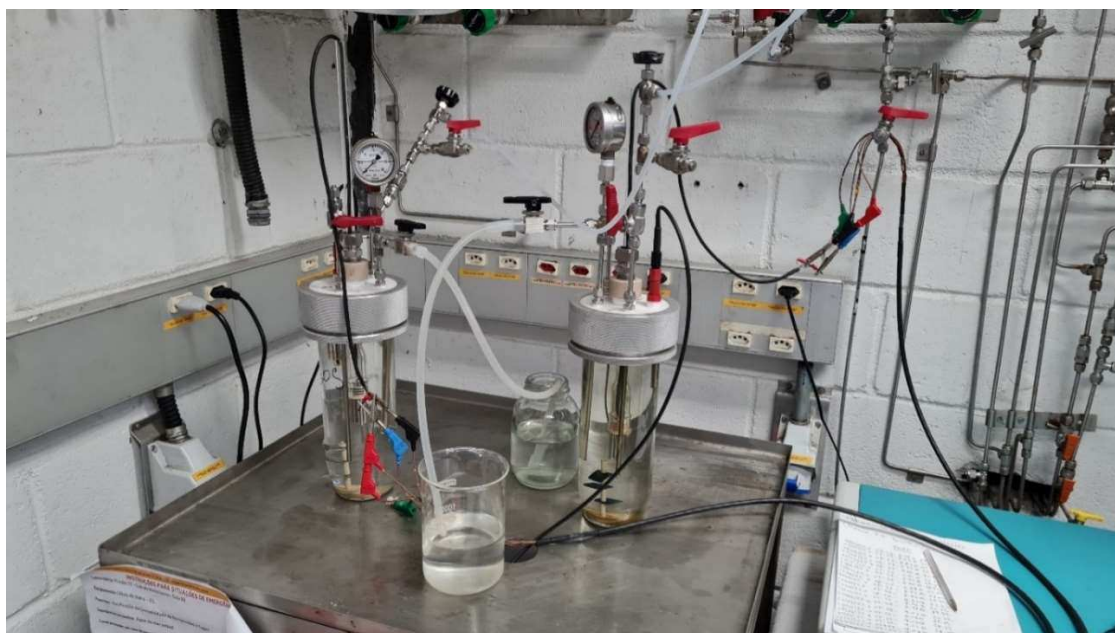
Figura 51. Células de vidro utilizadas nos ensaios de avaliação da corrosividade.
