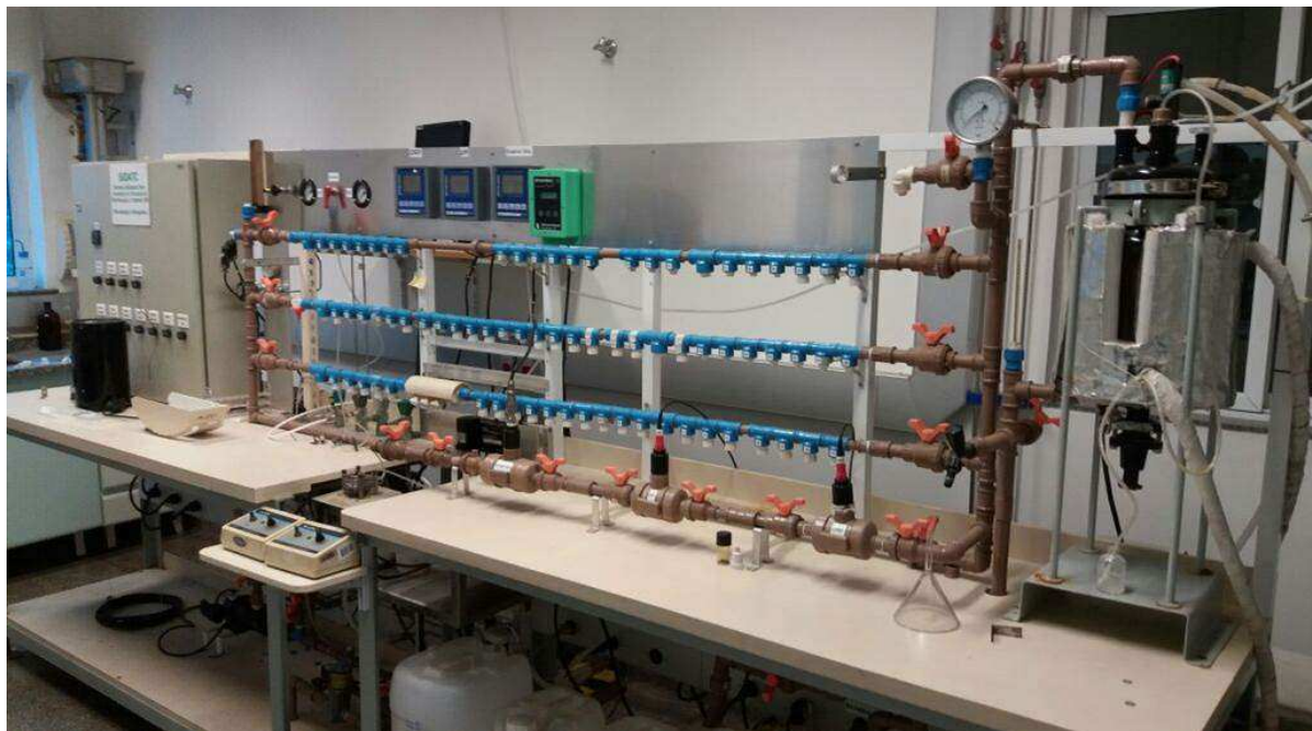
Figura 36. Sistema piloto laboratorial de fluxo dinâmico ( Looping ) do CENPES utilizado no primeiro estudo de avaliação do efeito de um coquetel fágico em biofilmes mistos de BRS de tanque slop de plataforma do tipo FPSO.
