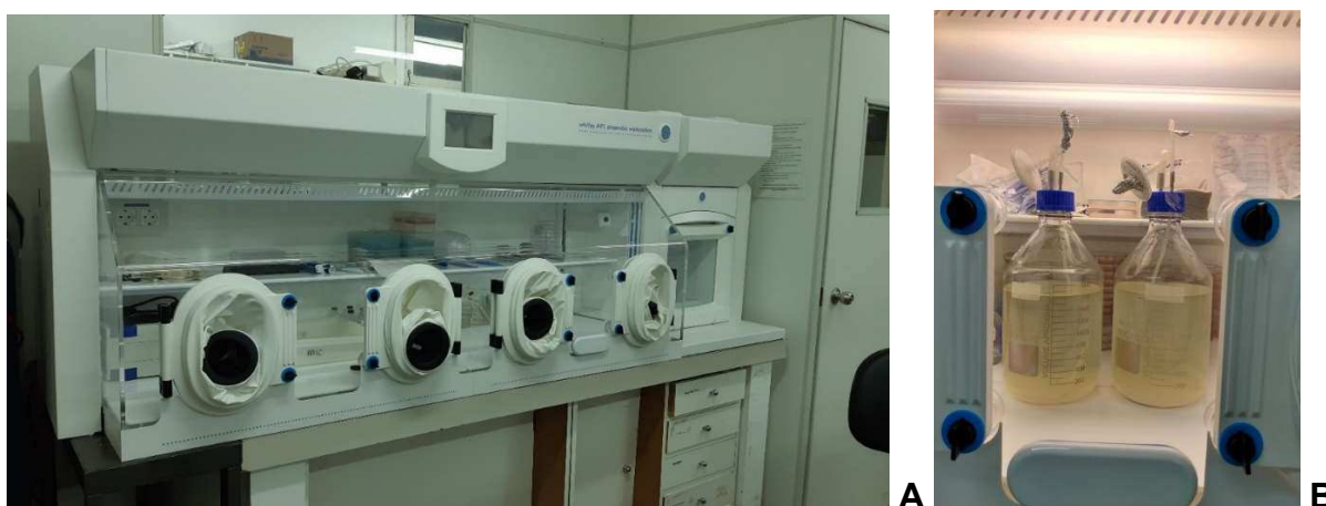
Figura 47. (A) Câmara de anaerobiose (Whitley A95) e (B) repique da cultura de BRS utilizadas para preparo do inóculo e inoculação nos sistemas piloto laboratoriais de fluxo dinâmicos ( Loopings ) da UFV.
