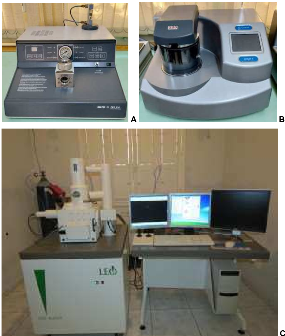
Figura A6. (A) Ponto Crítico, Critical Point Dryer - CPD ® , Balzers, modelo 030; (B) Evaporador de carbono, Quorum, modelo Q150T-E; e, (C) Microscópio Eletrônico de Varredura (MEV) Leo 1430 VP, do Núcleo de Microscopia e Microanálise (NMM) da UFV.
