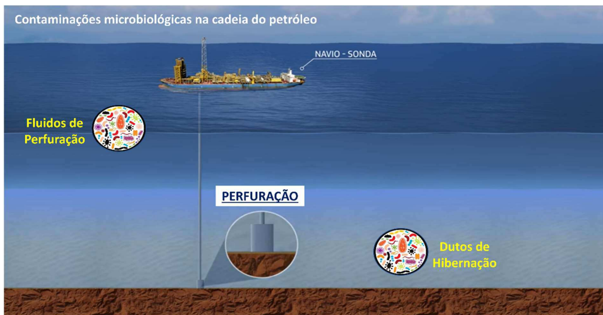
Figura 1. Sistemas da etapa de perfuração de poços de petróleo susceptíveis a problemas associados a contaminações microbianas (adaptado a partir de PETROBRAS, 2016).
