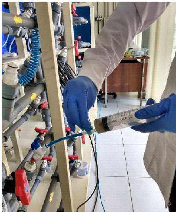
Figura 48. Procedimento de amostragem do fluido para realização das análises realizadas no estudo preliminar nos sistemas piloto laboratoriais de fluxo dinâmicos ( Loopings ) da UFV.
