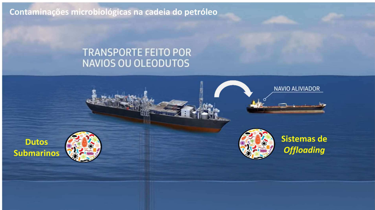
Figura 5. Sistemas da etapa de escoamento do petróleo em plataformas susceptíveis a problemas associados a contaminações microbianas (adaptado a partir de PETROBRAS, 2016).
