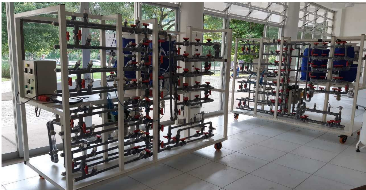
Figura 38. Sistemas piloto laboratoriais de fluxo dinâmicos ( Looping ) instalados no novo espaço do LIVM da UFV, projetados e construídos para a realização de ensaios de desenvolvimento da tecnologia de bacteriófagos para controle de biofilmes e BRS na indústria do petróleo em parceria do CENPES com a UFV.
