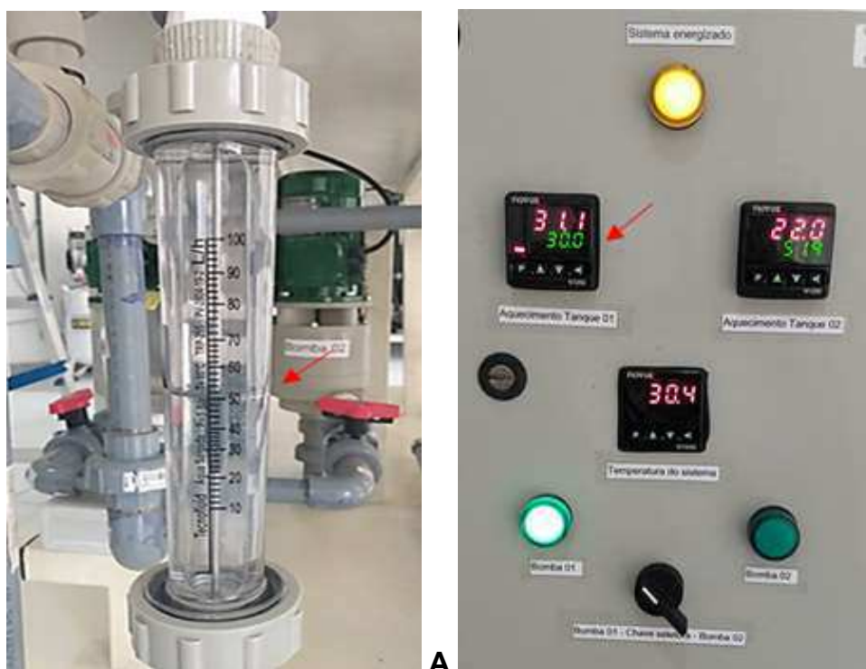
Figura 45. Controle de vazão e de temperatura dos sistemas piloto laboratoriais de fluxo dinâmicos ( Loopings ) da UFV. (A) Fluxômetro indicando (seta vermelha) a vazão de 50 L/h. (B) Painel de controle indicando (seta vermelha) o controle de 30^{\circ}\text{C} no tanque em operação.
