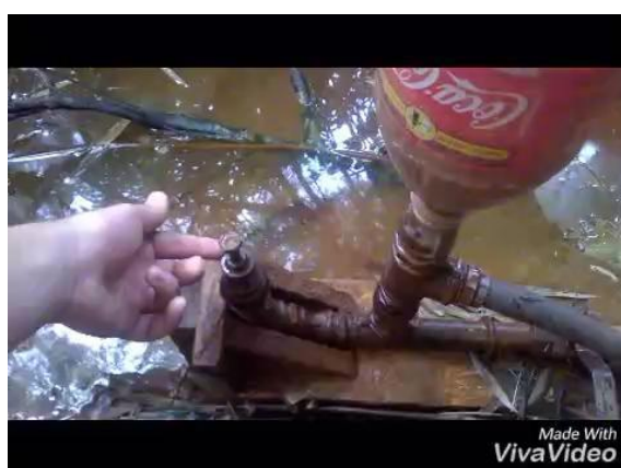
Figure 5 Frame from ‘Carneiro Hidráulico/Water Pump’.
