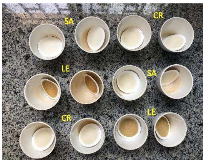
Figura 18. Aspecto das membranas da análise de SST após ensaio de tratabilidade do Experimento I. SA = sulfato de alumínio; CR = coagulante recuperado; LE = lodo de ETA
