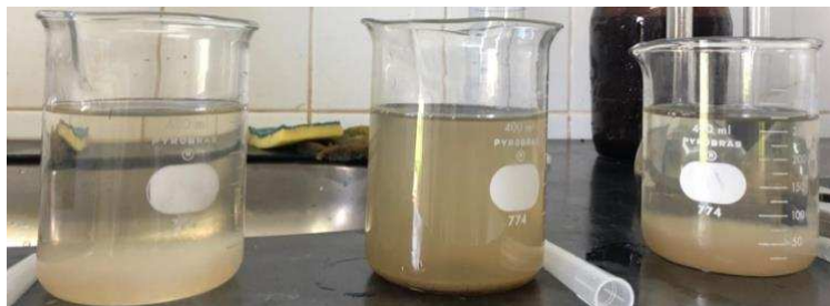
Figura 20. Ensaio preliminares para determinação da correção de pH no efluente de suinocultura para cada reagente de alumínio. Sulfato de alumínio (esquerda), lodo de ETA (centro) e coagulante recuperado (direita)
