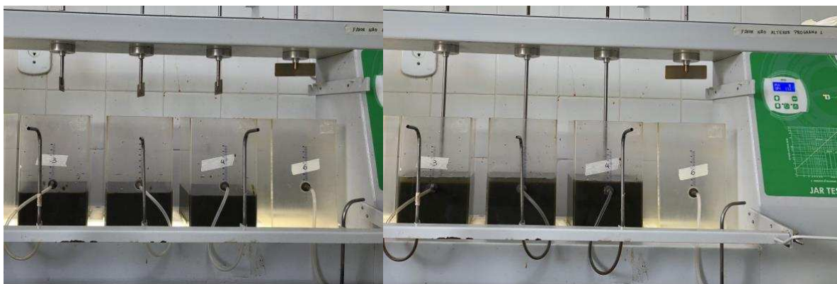
Figura 8. Lodo de ETA bruto (à esquerda) e após o ajuste para a concentração de sólidos de 2,0% (direita)
