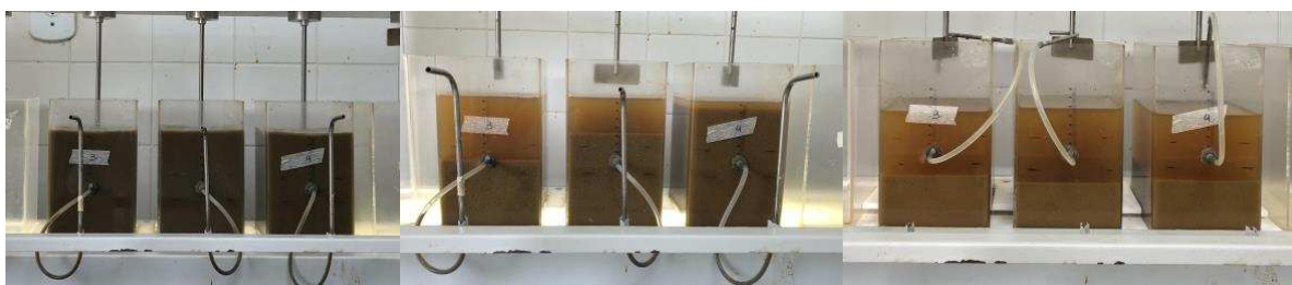
Figura 9. Ensaios de jarros para recuperação de coagulantes: amostras de lodo de ETA após a adição de ácido sulfúrico (esquerda), durante a separação de fases (centro) e após a separação de fases (direita)
