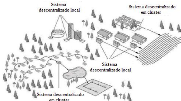
Figura 1.2 - Representação de sistemas descentralizados locais e em clusters .
