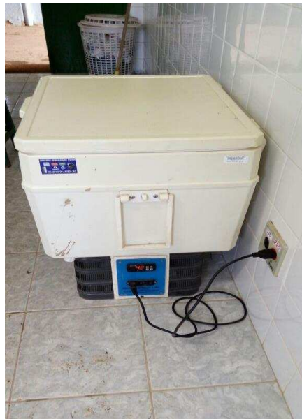
Figura 2 – Refrigerador Minitube® utilizado para resfriar as palhetas a 5 °C. Fonte: Arquivo Pessoal.
