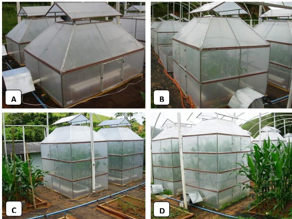
Figura 1.9 – Câmaras de topo aberto com acréscimo dos módulos para acompanhar o crescimento e desenvolvimento das plantas: A - Câmaras com um módulo; B - Câmaras com dois módulos; C - Câmaras com três módulos; e D - Câmaras com quatro módulos.
