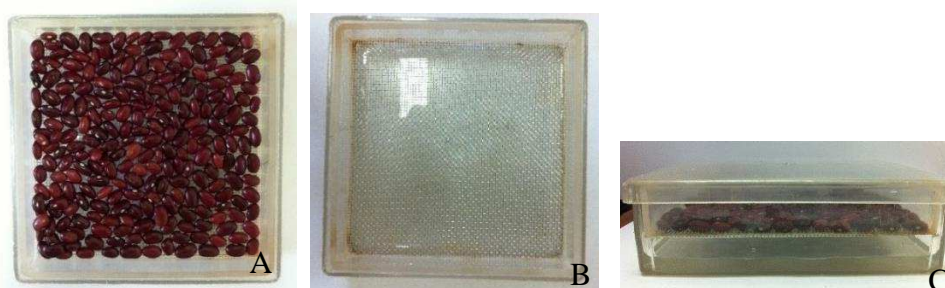
Figura 4. Detalhes do teste de envelhecimento acelerado: 200 sementes de feijão em camada única sobre a tela suspensa no interior do gerbox (A), 40 mL de água na parte inferior do gerbox (B) e visão lateral da disposição das sementes de feijão e água dentro do gerbox (C).
