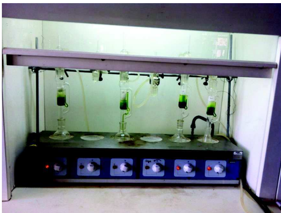
Figura 8.4 - Sistema de extração de lipídeos por soxhlet.
