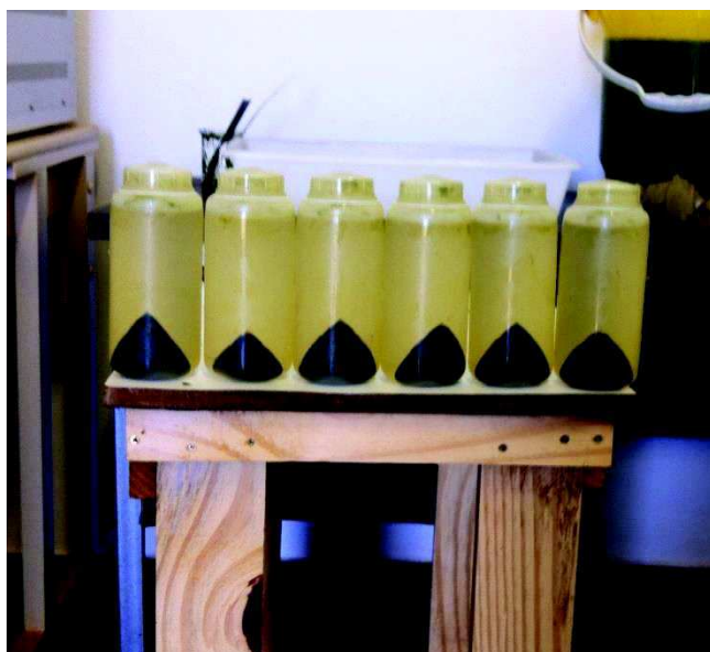
Figura 8.1 - Biomassa separada do conteúdo líquido após a centrifugação.
