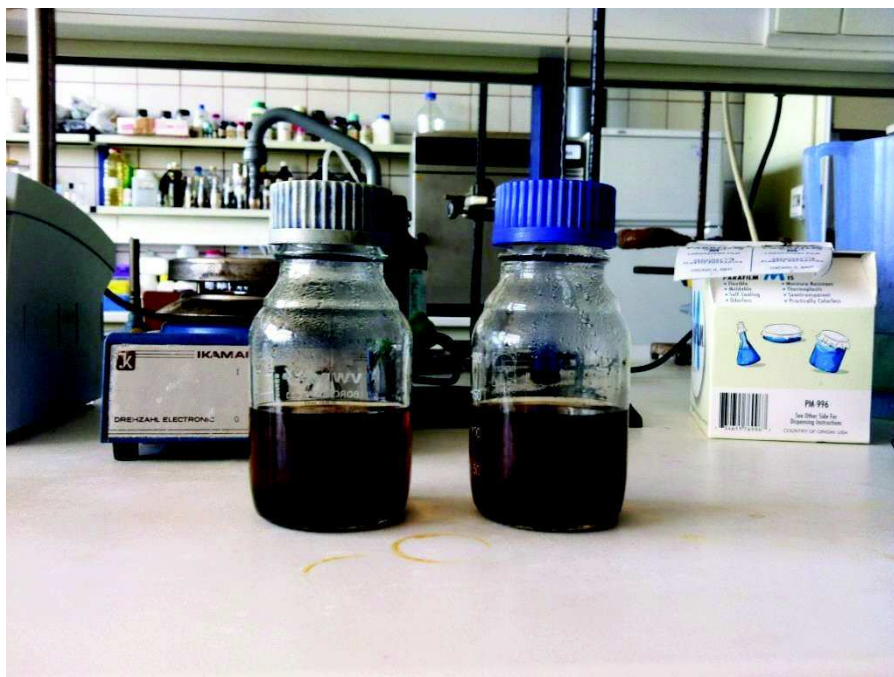
Figura 8.3 - Frascos de análise da concentração de carboidratos após o período na autoclave.
