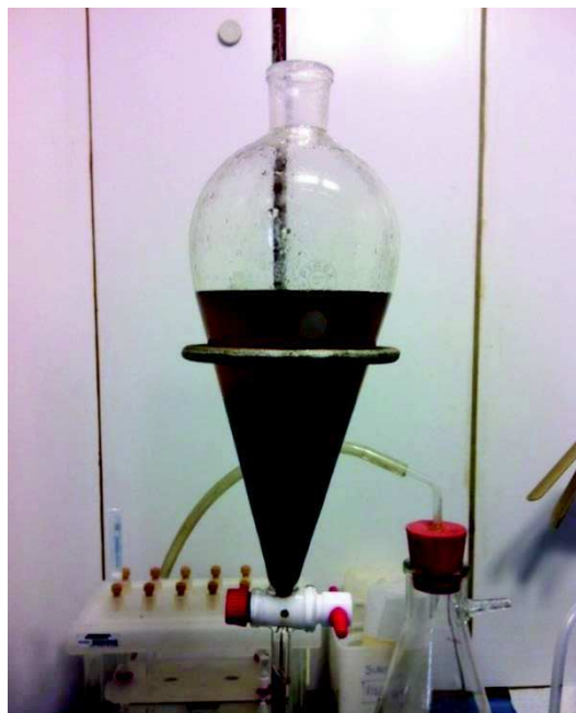
Figura 8.8 - Funil de separação com solução bifásica de água (superior) e DCM (inferior).
