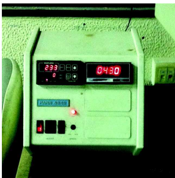
Figura 8.7- Controlador utilizado nos ensaios de LHT.
