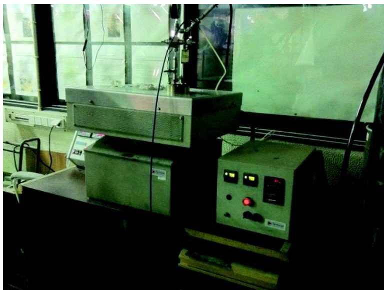
Figura 8.6 - Forno utilizado no aquecimento da autoclave.
