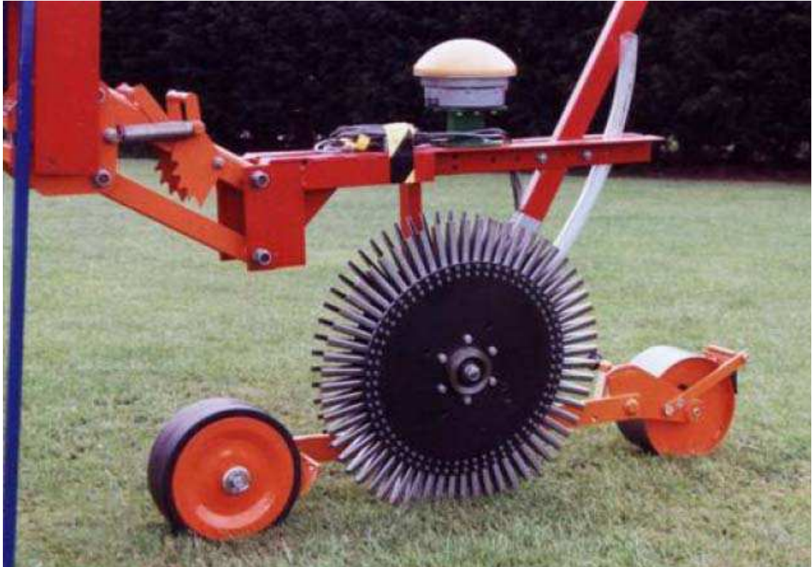
Figura 9 – Semeadora puncionadora com sistema de discos convergentes com desenvolvida por Resende (2002).
