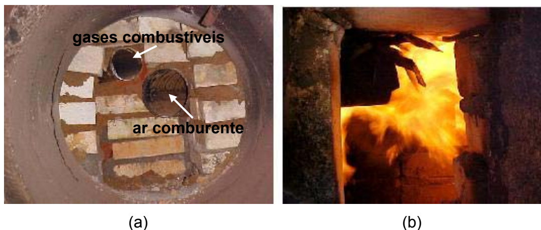
Figura 12 – (a) Visualização interna da ligação do reator de gaseificação com a câmara de combustão e (b) abertura lateral para introdução da chama piloto na ignição dos gases .
