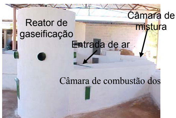
Figura 13 – Reator de gaseificação com câmara de combustão dos gases.
