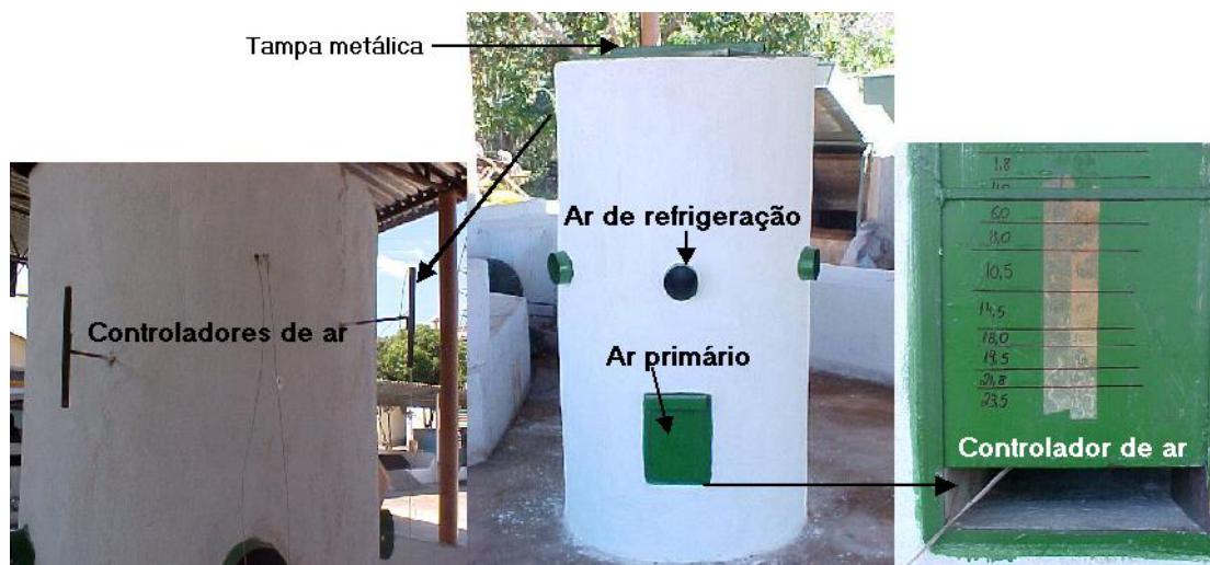
Figura 8 – Entradas e controladores de ar do reator de gaseificação.
