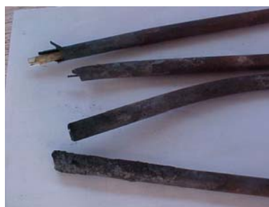
Figura 18 – Sondas danificadas pelas ações térmicas.
