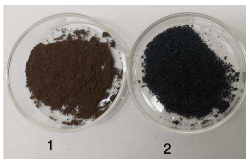
Figura 2.3 Imagens dos biocarvões produzidos em diferentes processos termoquímicos. Legenda: (1) HC-150. Condições: Processo hidrotérmico a 150 °C por 14 h. (2) PC-500. Condições: Pirólise sob atmosfera de N 2 a 500 °C por 1 h.
