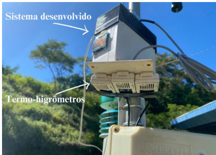
Figura 3 – Posicionamento dos equipamentos no processo de calibração do sensor de temperatura e umidade relativa do ar do sistema desenvolvido, em um ambiente aberto
