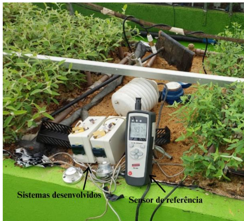
Figura 2 – Posicionamento dos equipamentos no processo de calibração do sensor de dióxido de carbono ( \text{CO}_2 ) do sistema desenvolvido dentro da mini casa de vegetação
