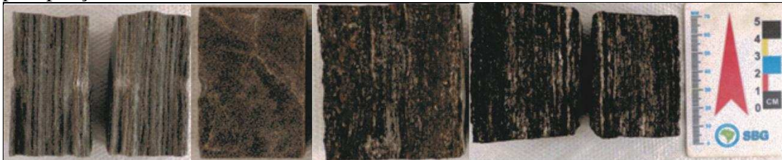
Figura 18 - Aspectos da matriz de filito W4 em que se observam cores variegadas, intemperismo dos níveis formados por minerais opacos, tornando a matriz rochosa friável e escura, além da precipitação de óxido e hidróxido de Fe
