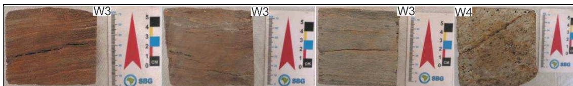
Figura 3.7 – Aspectos da matriz dos filitos intemperizados do perfil Fil03. As amostras do filito W3 foram coletadas de três pontos diferentes do perfil, demonstrando a heterogeneidade da rocha.
