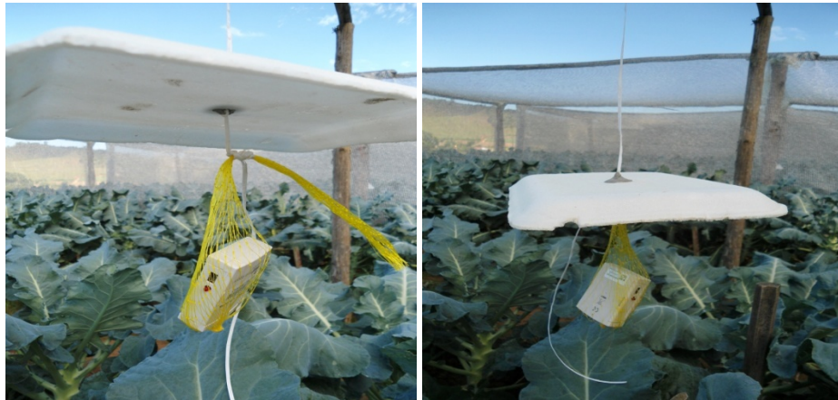
FIGURA 4. Datta Logger, instalados à altura do dossel das plantas, destinados ao registro das temperaturas máxima e mínima e da umidade relativa nos ambientes de cultivo.
