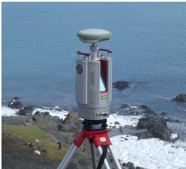
Figura 2 – Fotografia do equipamento TLS utilizado, com antena GPS acoplada ao mesmo.
