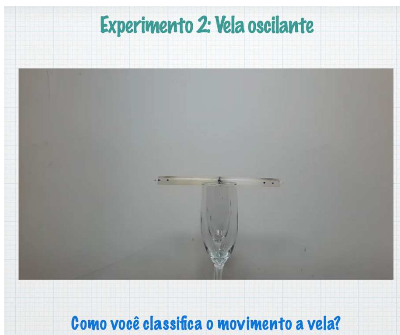
Figura 49 - Aparato experimental da vela oscilante
