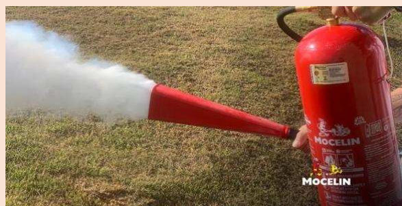
Figura 68 - Jato emitido por um extintor de CO 2
