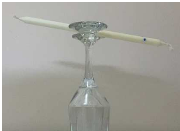
Figura 74 - Aparato experimental da vela oscilante
