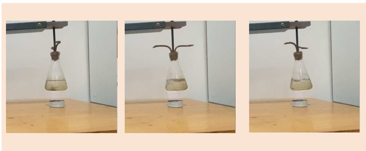
Figura 83 - Recortes do vídeo retratando o funcionamento do motor de Heron
