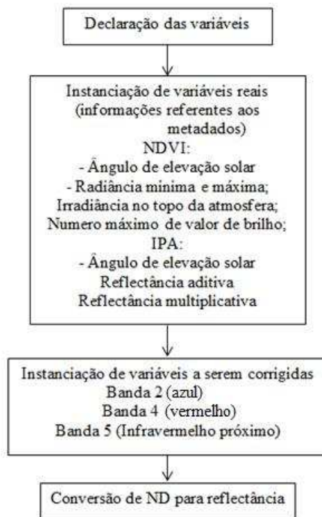
Figura 24 - Fluxograma usado na elaboração do algoritmo utilizado para a correção atmosférica das bandas OLI/Landsat 8, usadas na determinação dos índices NDVI e IPA.
