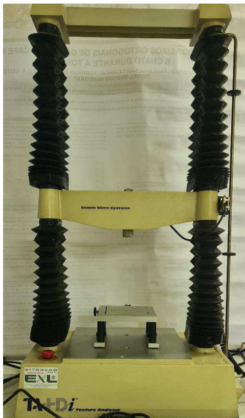
Figura 7. Máquina Universal de testes modelo TA.HD Texture Analyser, Stable Micro Systems. Fonte: Autora.
