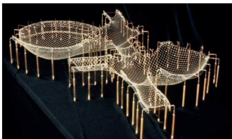
Figura 4 – Modelo físico da geração da forma do Multihalle and Restaurant .
