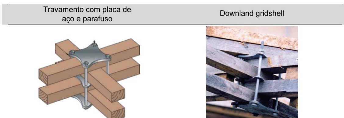
Figura 14 – Travamento com placa de aço e parafuso.
