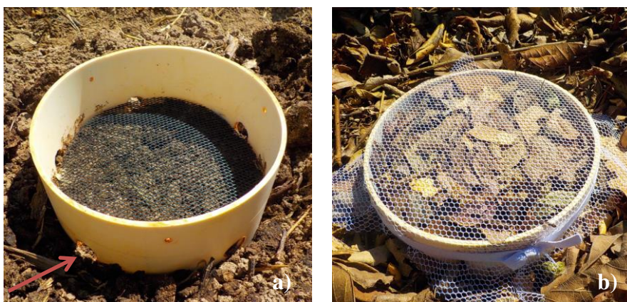
Figura 2. (a) Câmera de decomposição sem resíduos, com disco de tela plástica de 3 mm de malha e furos para entrada de macrofauna (b) Câmera com resíduo de capoeira e tecido de polietileno de 2 mm de malha.
