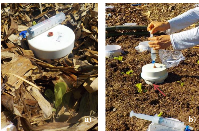
Figura 3. (a) Câmera de gases com septo de borracha e seringa de três vias e (b) coleta de gases com a seringa e peças de borracha tampando os orifícios da câmara.
